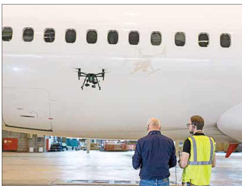
الدرونز تفحص الطائرات أثناء الصيانة الدورية
